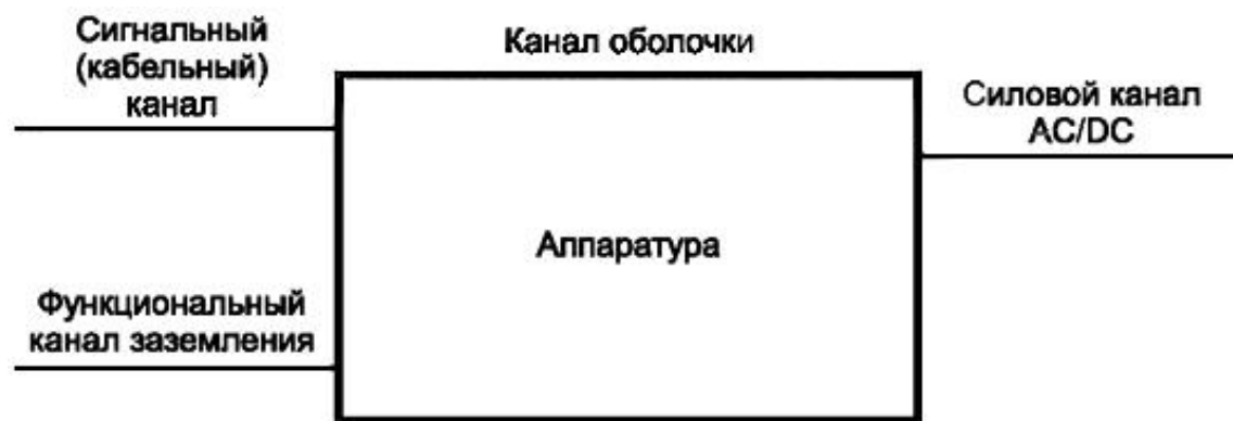
Рисунок J.1 - Примеры каналов (портов)
