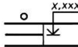
4.10. Проводка в трубе, прокладываемой от отметки трассы вверх
