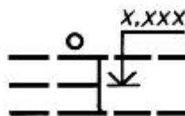
4.7. Проводка в трубе, прокладываемой скрыто (в бетоне, в грунте и т.п.), с указанием отметки заложения
