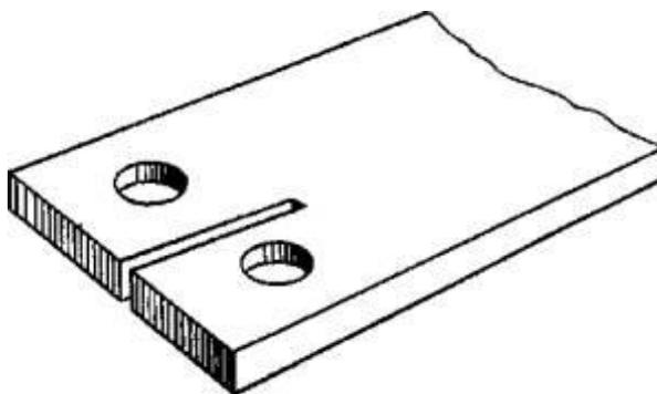
1. Контакт-детали, имеющие два и более отверстия под болты в поперечном ряду, рекомендуется выполнять с продольными разрезами, как показано на чертеже.
