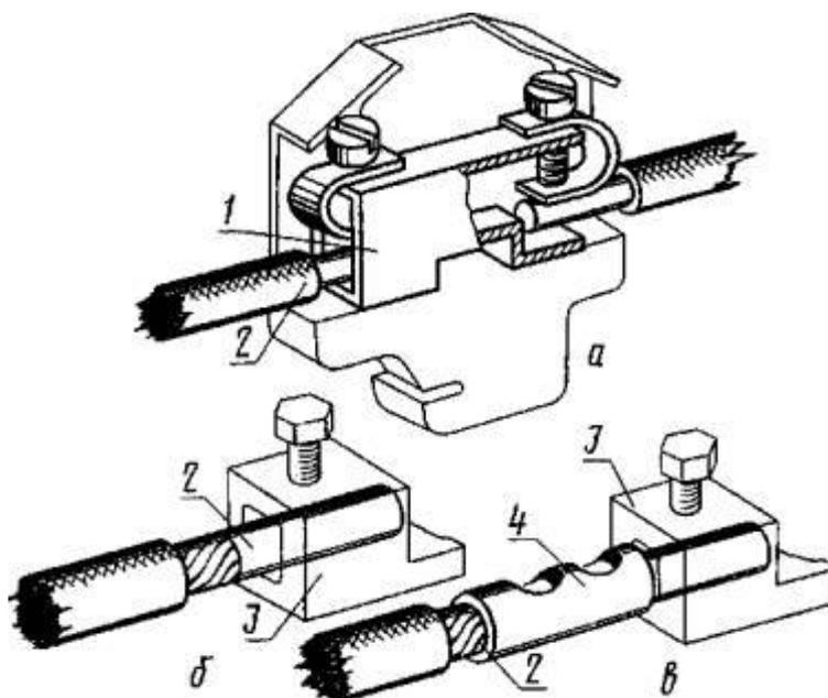
*а, б* - однопроволочная (многопроволочная, сплавленная в монолит) жила; *в* - многопроволочная жила, оконцованная кабельным наконечником
